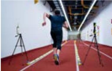
Ein 30-Meter langes, optisches Mess-System mit Sende- und Empfangsleuten, das jegliche Unterbrechungen der Kommunikation zwischen den Leisten erkennt und deren Dauer berechnet.
